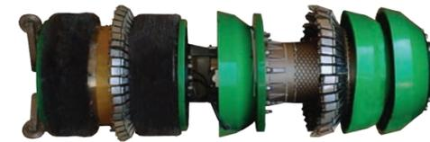
**PORCUPINE** - Internal Defect Mapping
